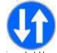
Comienzo de doble sentido de circulación
